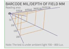
3mil Code39 40 ~ 60 mm 4mil Code39 35 ~ 85 mm 5mil Code39 35 ~ 95 mm 10mil Code39 25 ~ 150 mm 20mil Code39 20 ~ 200 mm 20 ~ 120 mm 20mil QR Code 20 ~ 90 mm 20mil PDF417 20mil Data Matrix 20 ~ 160 mm
